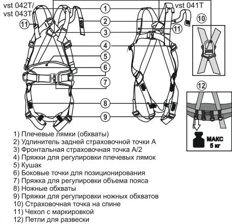
Рис. 2. Типы крепежных точек
