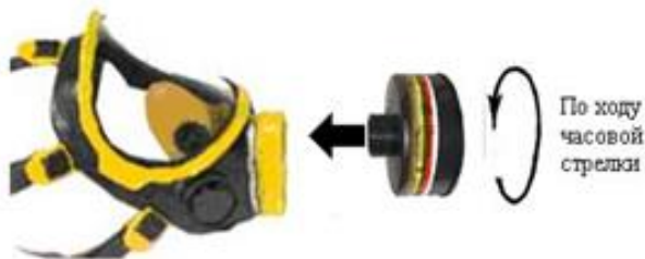
Рисунок 6 - Присоединение фильтра к маске МПГ-ИЗОД
